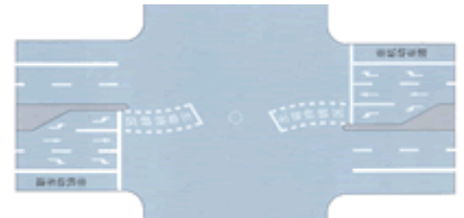
左弯待转区线（左弯车辆可在直行时段进入待转区，等待左转。左转时段终止，禁止车辆在待转区内停留）
