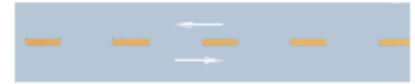
双向两车道路面中心线（分隔对向行驶的交通流，在保证安全的情况下允许车辆越线超车或左转弯）
