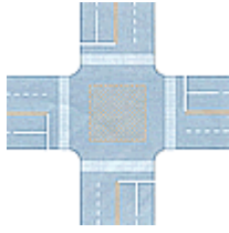
网状线（用以告示驾驶人禁止在该交叉路口临时停车）
