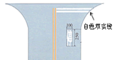
停车让行线（表示车辆在此路口必须停车让干道车辆先行）
